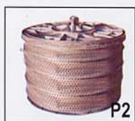
Panier pressable et essorable provenant d'autoclave (fibres en bourre)
