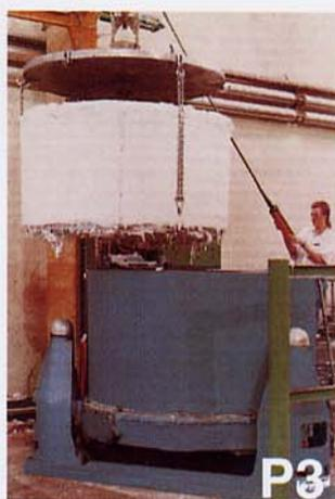
Essoreuse avec plaque de fond et chaînes pour gâteaux de bourre en sortie d'autoclave : Type KGA
