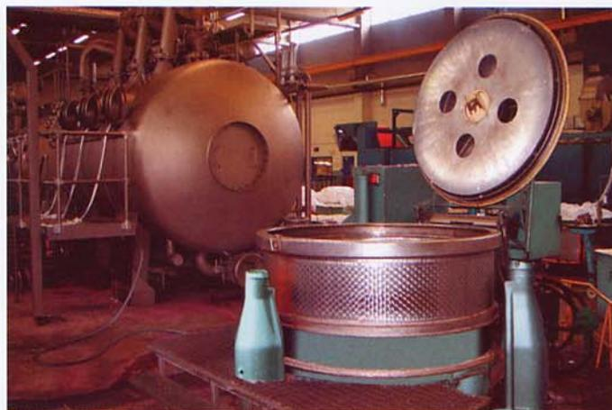
Essoreuse à relevage de l'ensemble "couvercle/dessus de panier" automatique.
